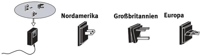
5. Stecken Sie das Kabelende des mitgelieferten Netzteils in den **POWER-**Anschluss des Druckerservers und das eigentliche Netzteil in eine Steckdose.
